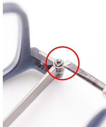
Vorsicht beim Entfernen der Gewindehülse. Achten Sie darauf, dass der Schraubendreher genauso groß ist wie von der geschlitzten Gewindehülse.
